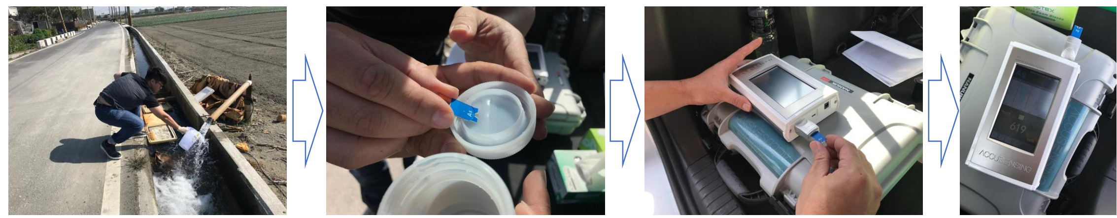
圖1、GNPs-SPE 搭配手持式電化學分析儀現地偵測地下水中三價砷
